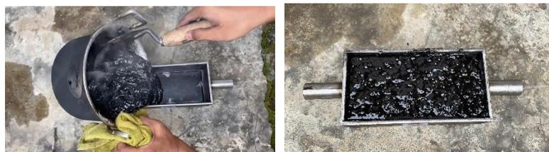
Gambar 2 Proses pembuatan paving block
