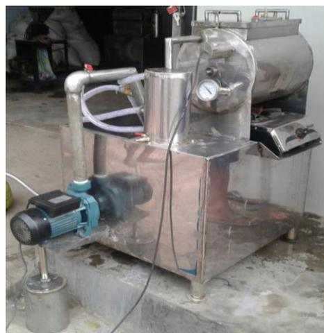
Gambar 1. Rancangan Struktural dan Unit Mesin *Vacuum frying*
