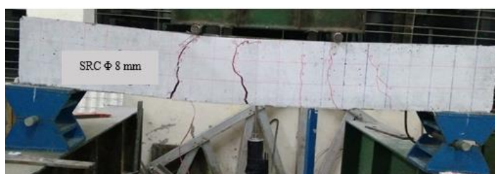
Gambar 10. Pola retak balok beton bertulang baja (SRC)
