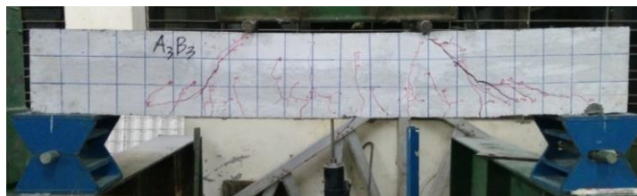
Gambar 9. Pola retak balok beton bertulang bambu (BRC)
