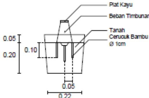
**Gambar 9.** Desain Potongan Pengujian Kuat Tekan Bebas Menggunakan Cerucuk Bambu
