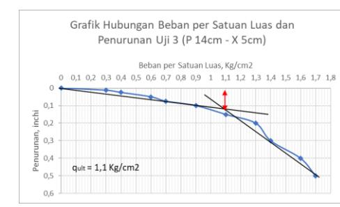
**Gambar 12.** Hubungan Beban per Satuan Luas dan Penurunan Uji Variasi Terkuat (P 14cm - X 5cm).
