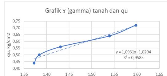
**Gambar 8.** Perbandingan Gamma Tanah dengan Kuat Tekan Bebas.
