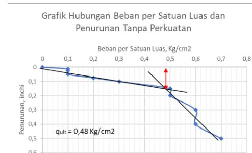
**Gambar 11.** Hubungan Beban per Satuan Luas dan Penurunan Uji Tanpa Perkuatan.
