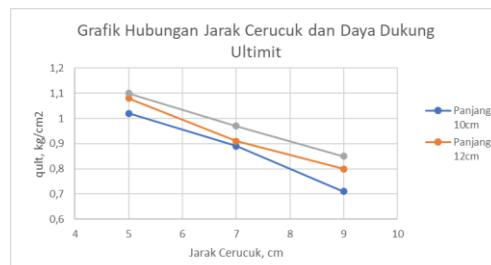
**Gambar 14.** Hubungan Jarak Cerucuk dan Daya Dukung Ultimit.
