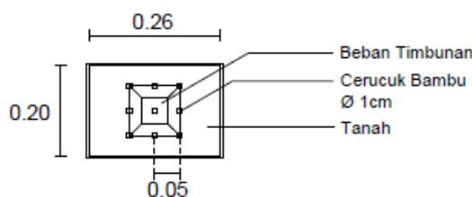
**Gambar 10.** Desain Tampak Atas Pengujian Kuat Tekan Bebas Menggunakan Cerucuk Bambu.
