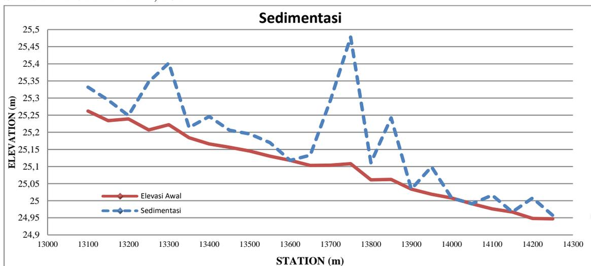
**Gambar 7.** Sedimentasi di Dasar Saluran Setelah Analisis HEC RAS
