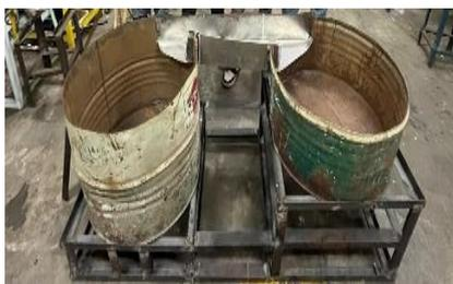
**Gambar 15.** Hasil Pembuatan turbin Vortex
