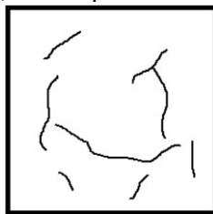
Gambar 7 Jenis retak kondisi lingkungan Sumber :Hasil penggambaran sendiri, 2023
