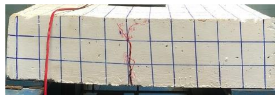
Gambar 20 Hasil Validasi Pola Retak Aplikasi DIANA FEA dan Eksperimen Pelat beton 60 x 60 cm.
