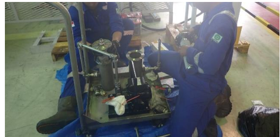
Gambar 3. Perakitan Alat Filtrasi Skid Sumber: Dokumentasi Penelitian, 2025.
