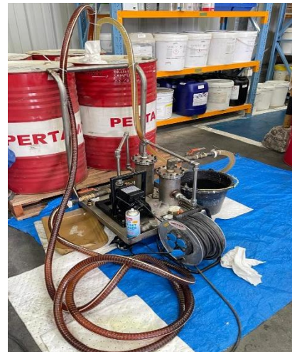
Gambar 4. Uji coba alat filtrasi Sumber: Dokumentasi penelitian, 2025.
