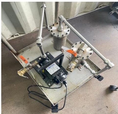
Gambar 2. Alat Filtrasi Skid Sumber: Dokumentasi Penelitian, 2025.
