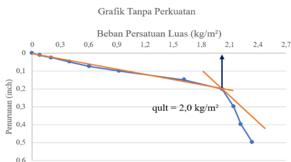
Gambar 13. Hubungan Beban Persatuan Luas dan Penurunan Tanpa Perkuatan Sumber : Hasil Perhitungan, 2025
