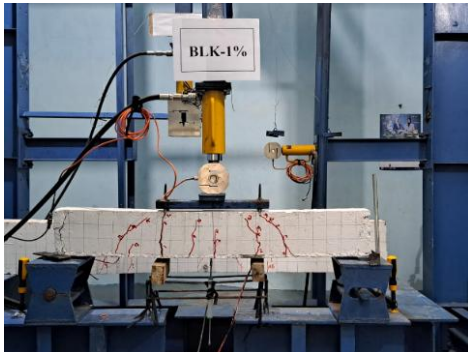
Gambar 11. Keruntuhan pada Balok BLK-1% Sumber : Hasil Penelitian, 2024.
