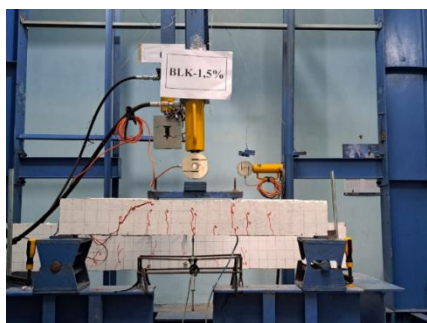
Gambar 12. Keruntuhan Balok BLK-1,5% Sumber : Hasil Penelitian, 2024.
