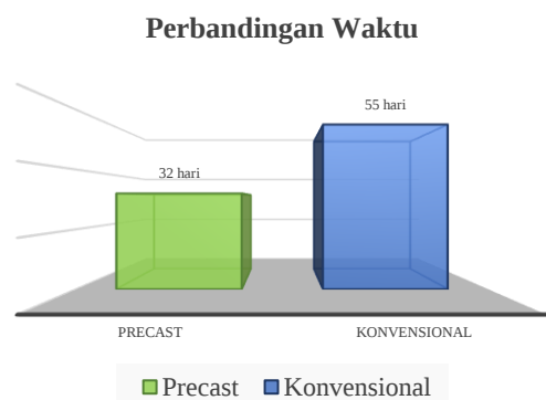
Gambar 8. Diagram Perbedaan Durasi Waktu beton Precast dan Konvensional Sumber: Hasil Perhitungan, 2025.
