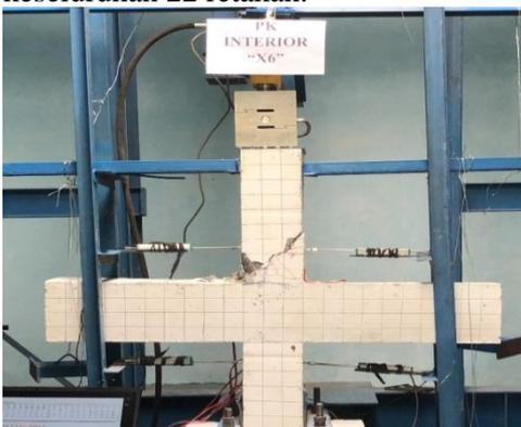
**Gambar 18.** Pola Retak PK INTERIOR X6
