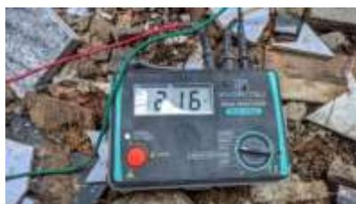
Gambar 7. Hasil Pengukuran Pentanahan Area Lift Masjid
