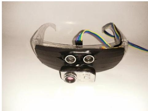
Gambar 13. Kacamata Dengan Kamera Dan Sensor HC SR04
