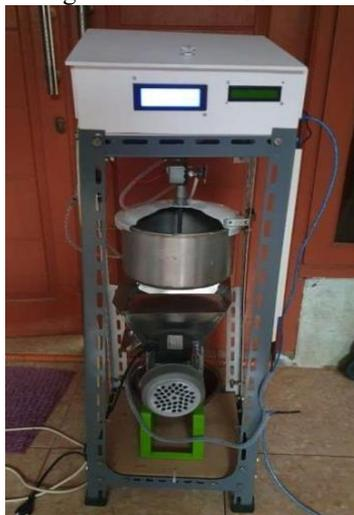
Gambar 16. Alat Pengering dan Penggiling Cabai Otomatis
