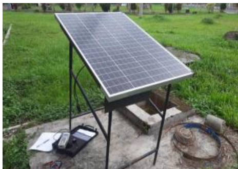
Gambar 3. Uji coba efisiensi panel surya
