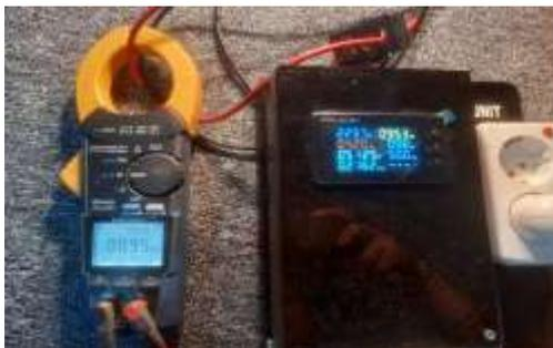
Gambar 5. Daya yang terukur di alat tera portabel dan di amper pembanding
