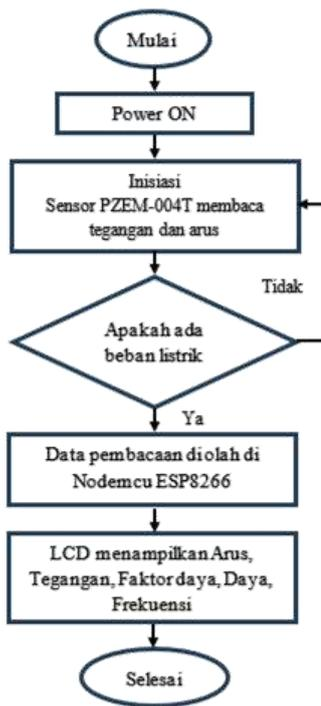
Gambar 2. Flowchart sistem kerja alat
