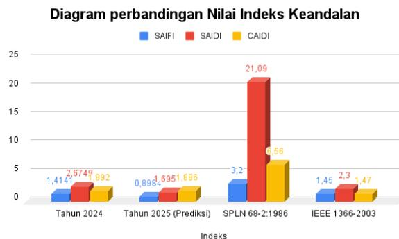
Gambar 5. Diagram perbandingan nilai indeks keandalan dengan standar
