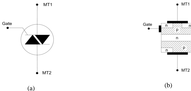
Gambar 4. (a) Simbol TRIAC (b) Struktur dasar TRIAC
