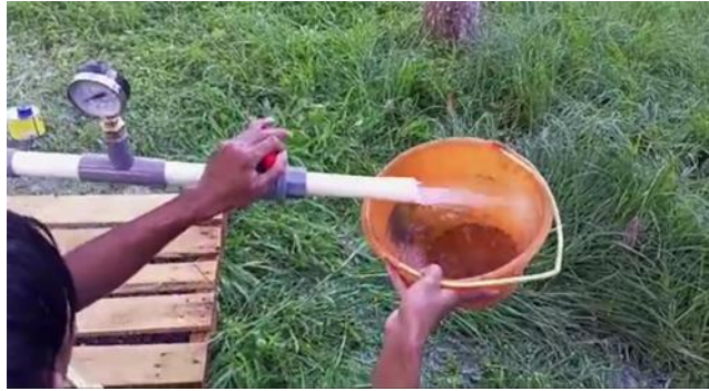
Gambar 9 Pengukuran debit keluaran pompa
