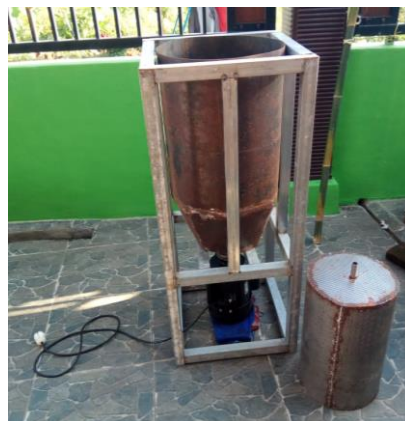
Gambar 4: Hasil perakitan alat penyaring screw
