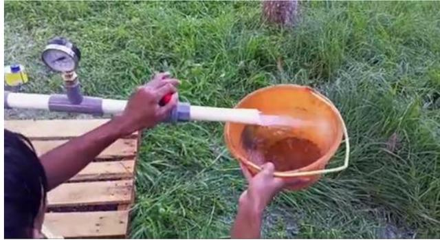
Gambar 9 Pengukuran debit keluaran pompa
