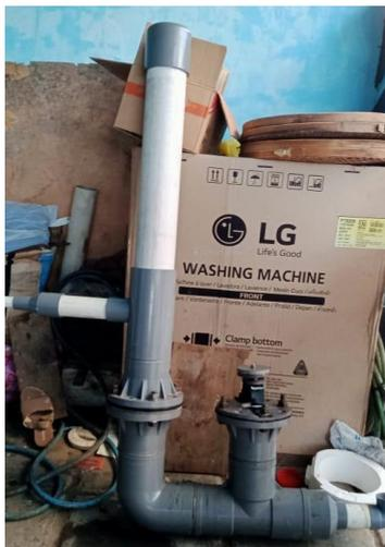
Gambar 6 Hasil pompa hidram yang dibuat
