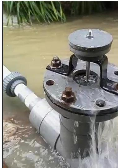
Gambar 10 Pengujian pompa hidram di sungai Desa Pakistaji
