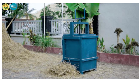
Gambar 7. Alat pengepresan jerami untuk membuat baleage sebagai pakan ternak
