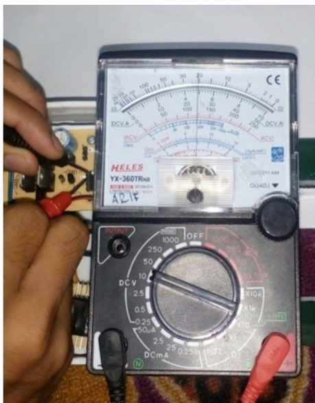
Gambar 15. Pengujian voltage (voltage)
