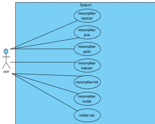
Gambar 1 Use Case Diagram Pengguna
