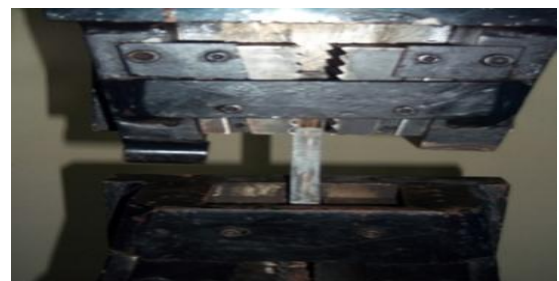
Gambar 1. Uji tarik material Komposit di mesin
