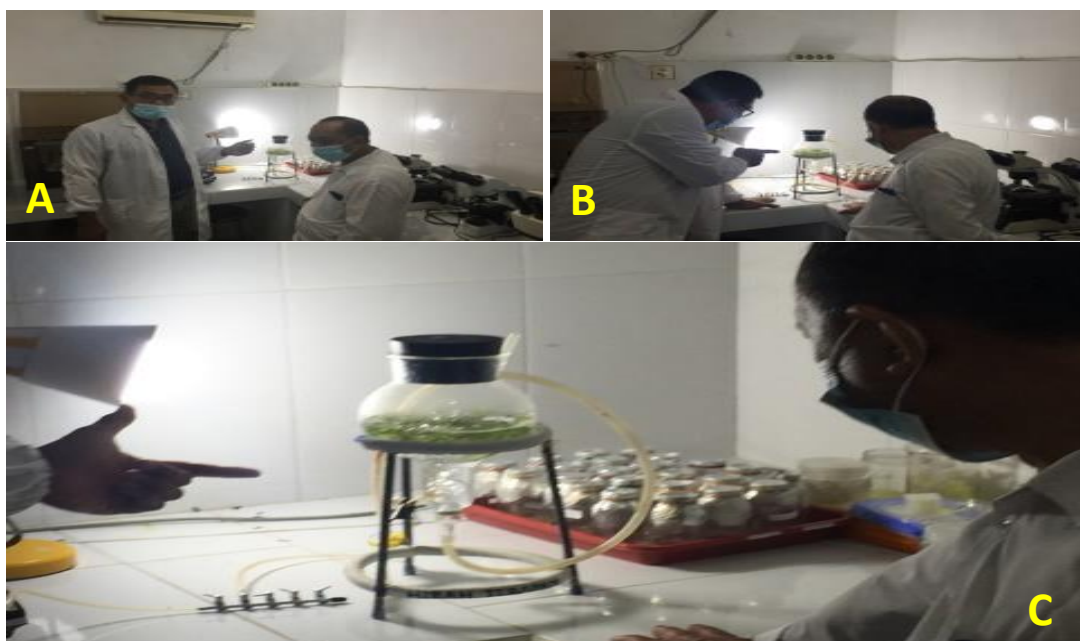
Gambar 4. A, B, dan C: Bioreaktor untuk memperbanyak anggrek secara masal dari biji atau klonal
