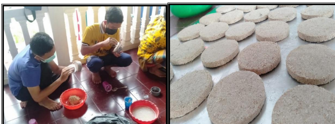
Gambar 3. Proses pencetakan dan hasil papan partikel sert tebu
