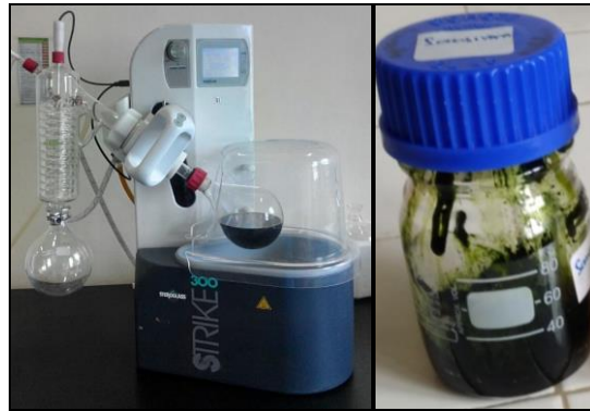
Gambar 3. Hasil saringan yang telah di evaporator
