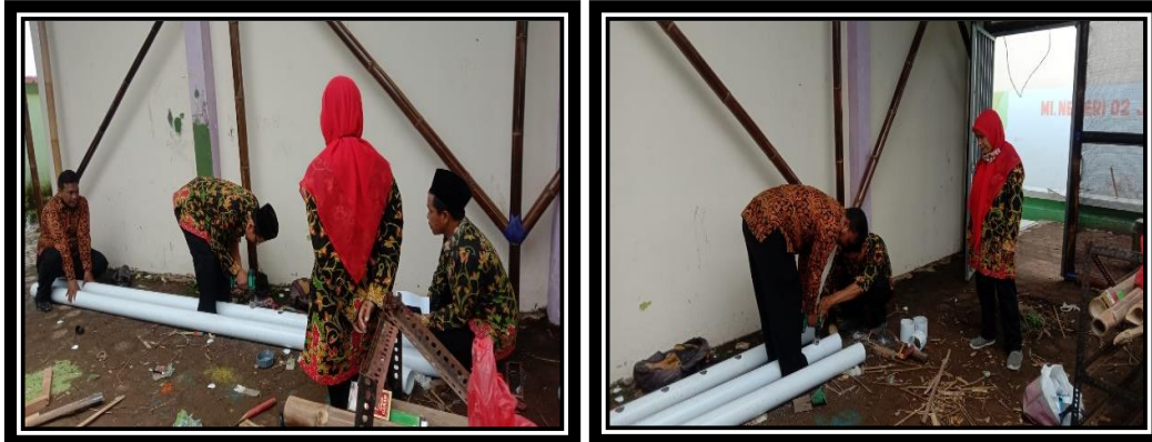
Gambar 2. Foto Kegiatan Guru Praktek Membuat Lubang pada Pipa PVC
