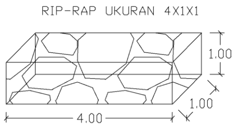
Gambar 9. Desain Rip-Rap Tipe C Sumber : DED Gambar Perencanaan
