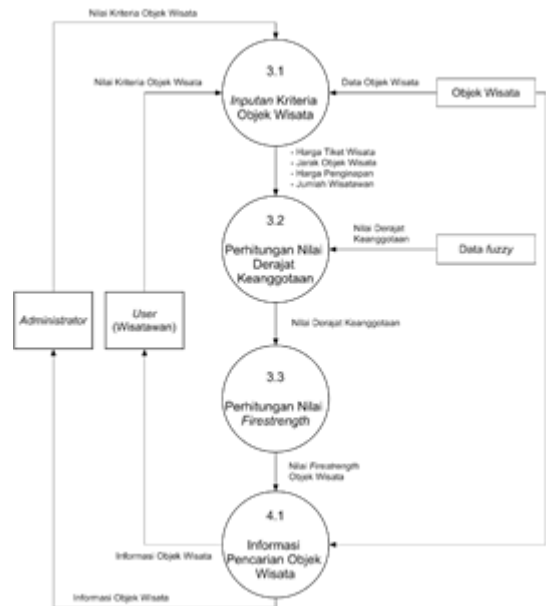
Gambar 4. DFD Level 2 Proses Perhitungan Derajat Keanggotaan
