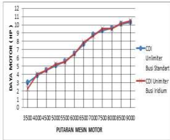
Gambar. 2 Grafik 2 Perbandingan Daya CDI Unlimiter Menggunakan Busi standart dan Iridium ( di ambil dari hasil terbesar )
