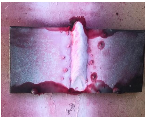
Gambar 8. Hasil Uji Penetrant Media Oli SAE20. (Sumber:Dok Pribadi,2024)
