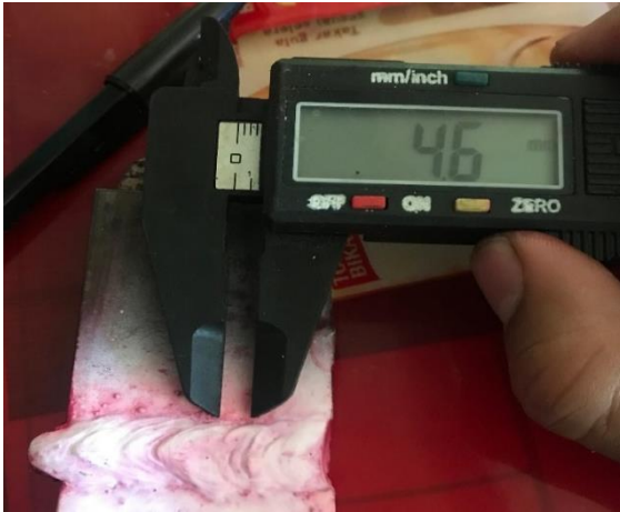
Gambar 7. Hasil Pengukuran Indikasi Penetrant Media Coolant (Sumber:Dok Pribadi,2024)
