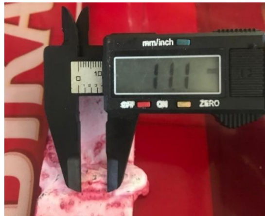
Gambar 5. Hasil Pengukuran Indikasi Penetrant Media Air (Sumber: Dok Pribadi, 2024).
