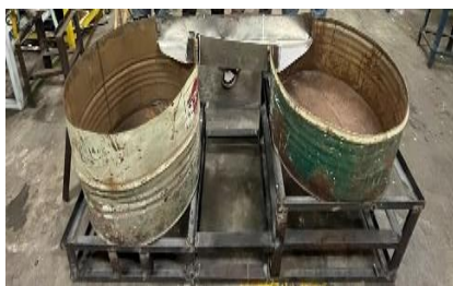
Gambar 15. Hasil Pembuatan turbin Vortex Sumber: Hasil Penelitian, 2024
