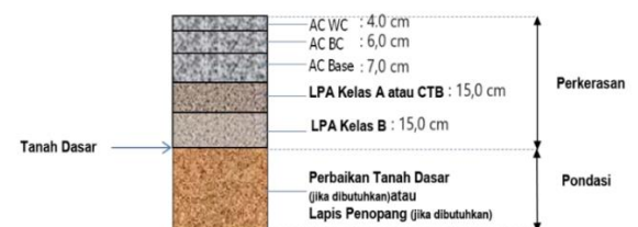
Gambar 5. Struktur Perkerasan Lentur (Flexible Pavement) dengan tebal 47 cm Sumber : Hasil Penelitian, 2023
