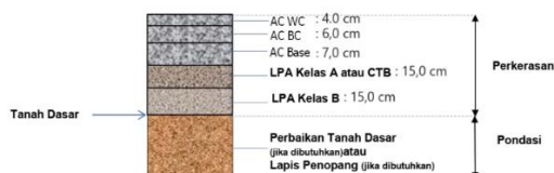
Gambar 3. Struktur Perkerasan Lentur (Flexible Pavement) dengan tebal 47 cm Sumber : Hasil Penelitian, 2024
