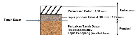
Gambar . Struktur Perkerasan Kaku (Rigid Pavement) dengan tebal 28,5 cm Sumber : Hasil Penelitian, 2023
