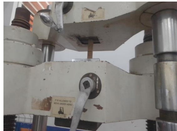
Gambar 11 Pengujian Kuat Tarik Bambu Sumber : gambar pribadi, 2023
