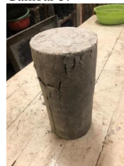
Gambar 5. Pola retak beton pada pengujian kuat tekan silinder beton dalam penelitian
