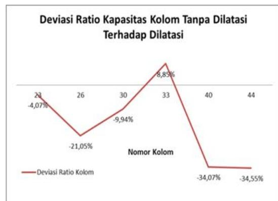
**Gambar 10.** Grafik Deviasi Ratio Kapasitas Kolom dengan Dilatasi dan Tanpa Dilatasi
