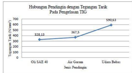
Gambar 4. Grafik Hubungan Pendingin dengan Tegangan Tarik Pada Pengelasan TIG
