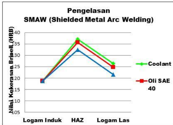
Gambar 2. Grafik Nilai Kekerasan pada Pengelasan SMAW ( Shielded Metal Arc Welding )
