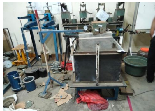
Gambar 4. Pemodelan pengujian abutment dengan menggunakan shaking table .
