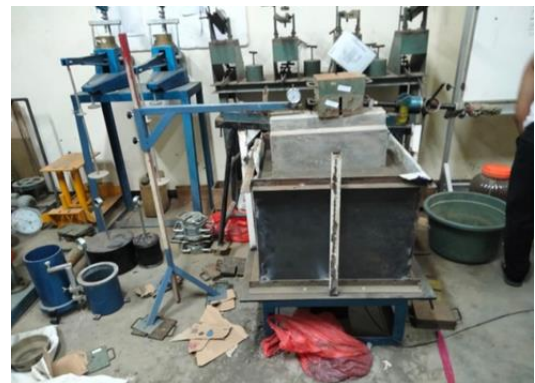
Gambar 4. Pemodelan pengujian abutment dengan menggunakan shaking table .
