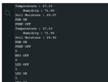
Gambar 23. Tampilan *output* keseluruhan pada serial monitor Arduino IDE
