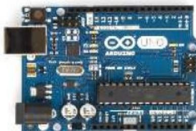
Gambar 1. Mikrokontroler Arduino Uno [5]
