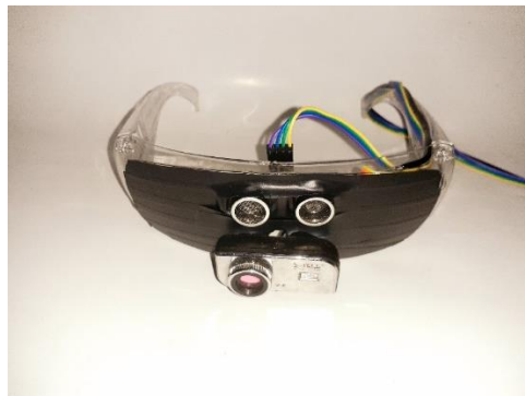
Gambar 13. Kacamata Dengan Kamera Dan Sensor HC SR04
