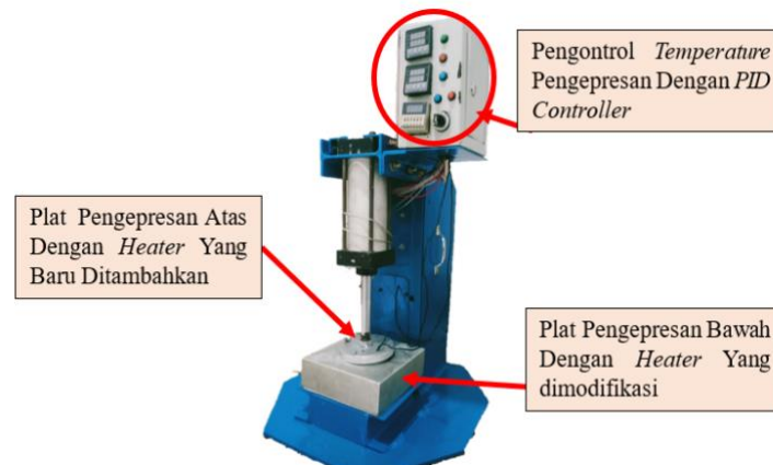
Gambar 5. Mesin hot press pelepah pinang setelah dimodifikasi
