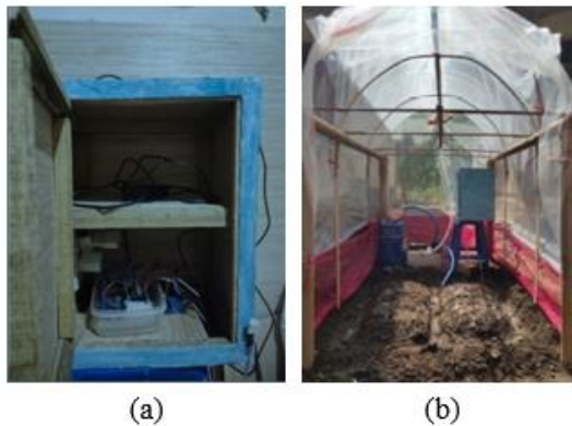
Gambar 10. Hasil perancangan (a) Box kontrol, (b) Prototipe smart greenhouse
